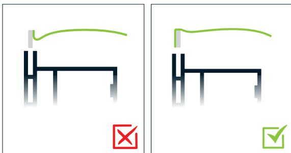
Der Flachkeder wird nach Innen eingeklappt, um eine gleichmäßige Spannung des Druckes zu erzielen.
