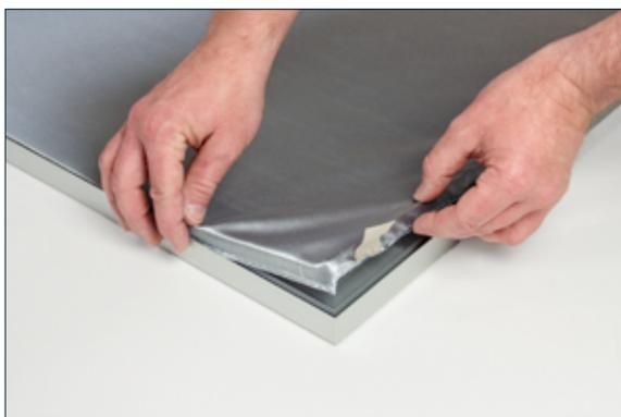
An einer Ecke beginnend drehen sie den angenähten Flachkeder mit beiden Händen um 90° nach innen, und fügen diesen in die Nut des Rahmens ein. So verfahren Sie an allen vier Ecken und den Längsseiten.
